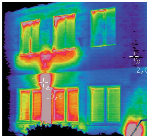
Wärmeverlust eines Gebäudes konventioneller Bauweise
