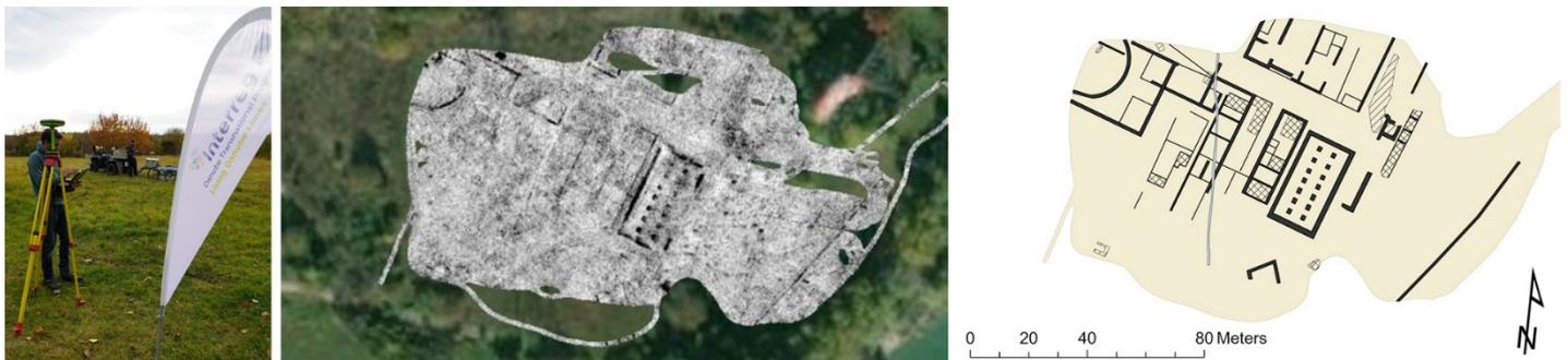
Fotos von LBI ArchPro: Foto links: Aufbau des GPR-Systems in Százhalombatta; Foto Mitte: Vermessungsfeld im Bereich des Römerkastells; Foto rechts: Interpretation der GPR-Daten, die römische Gebäudestrukturen zeigen.
