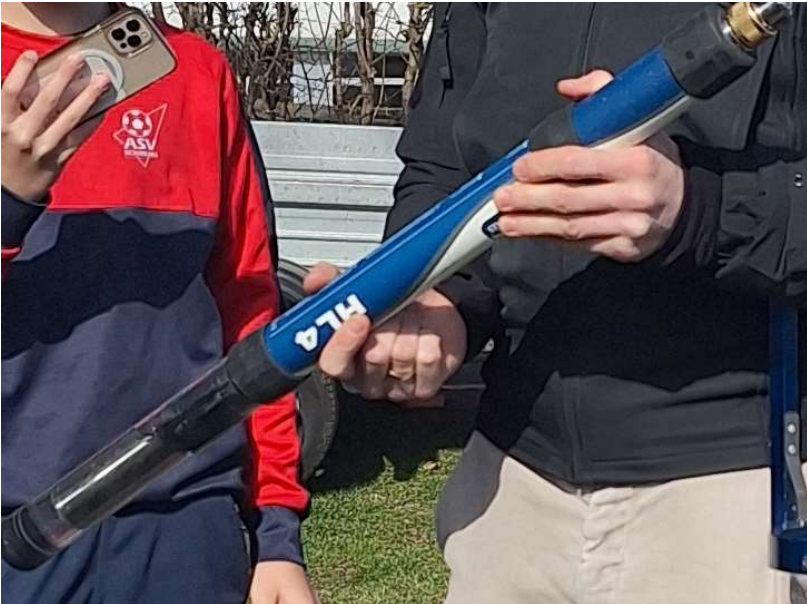
Sonde misst Sauerstoff, ph-Wert, Temperatur, Chlorophyll
