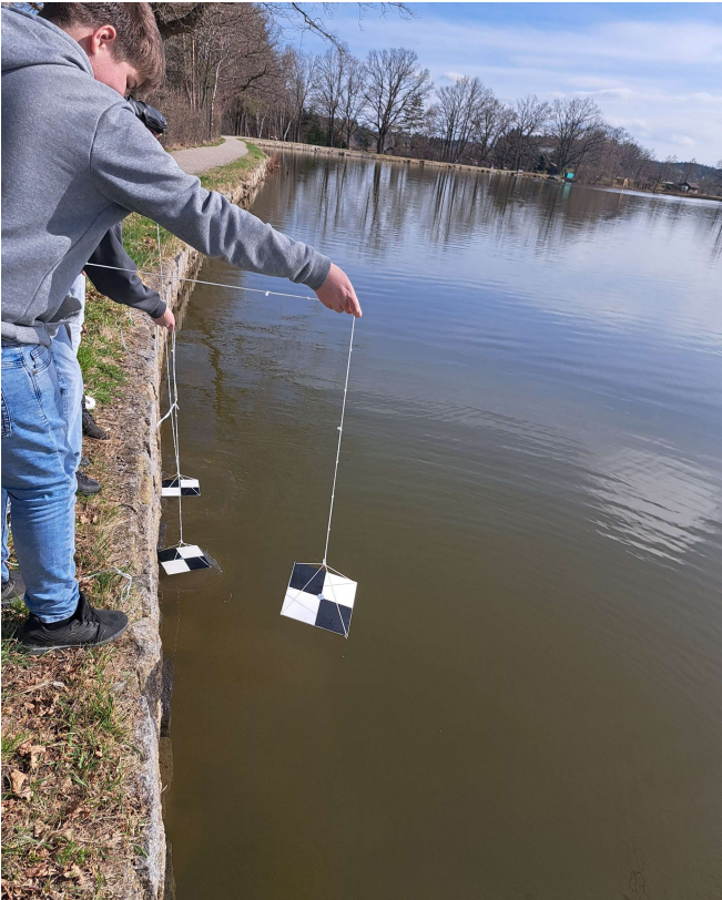
Secchischeibe um den Nährstoffgehalt im Teich zu messen
