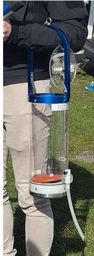
Schindlerschöpfer um Proben aus einer beliebigen Tiefe zu entnehmen
